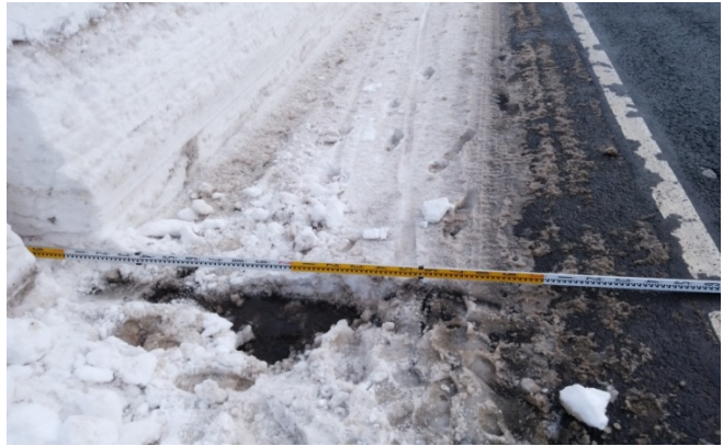
写真 6.9 拡幅除雪後の二次堆雪幅 (平成 31 年 1 月下旬：R236 号清陵)
