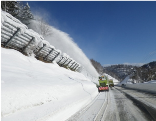
写真 6.8 ロータリ除雪車による拡幅除雪 (R236 号清陵)
