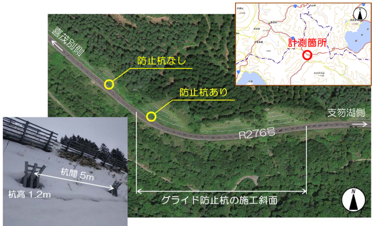
図 6.4 試験位置と計測箇所に設置されているグライド防止柵の概要 (GoogleEarth に加筆)
