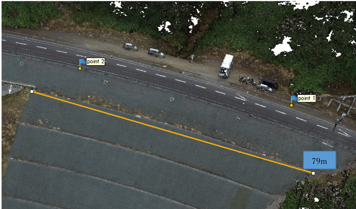
図 2.12 SfM ソフトによる距離の測定例
