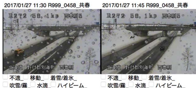
図 8.33 自動判別に失敗したカメラ前面の着水画像の事例（1）
