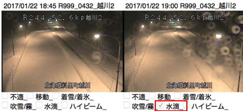
図 8.31 自動判別に成功したカメラ前面の着水画像の事例（1）
