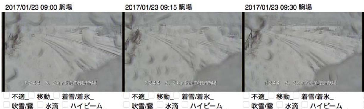
図 8.33 自動判別に失敗したカメラ前面の着水画像の事例（1）
