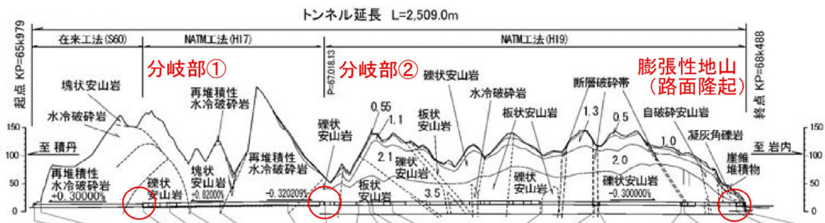
図 6.25 大森トンネル地質縦断面図
