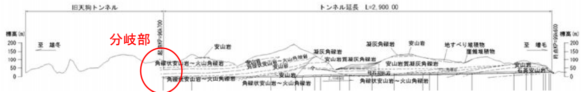
図 6.7 日方泊トンネル地質縦断面図
