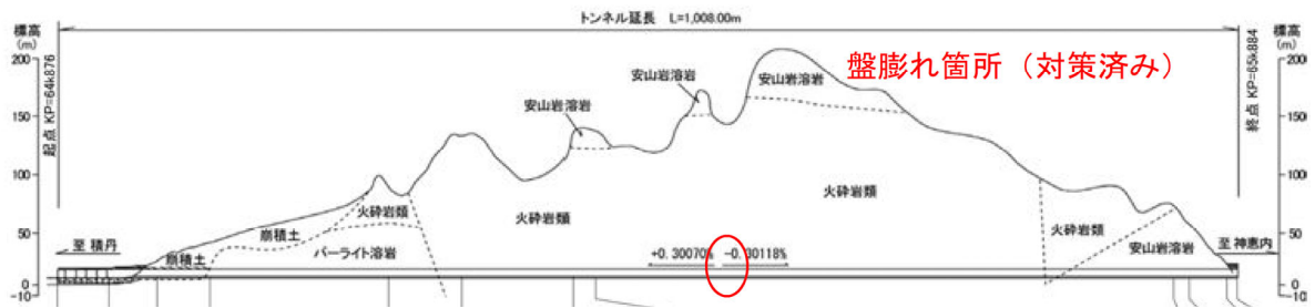
図 6.24 キナウシトンネル地質縦断面図
