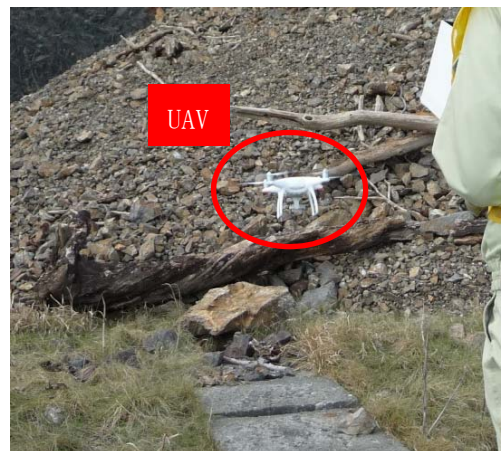
写真 3.4 覆道上の土石流堆積物と UAV 調査状況
