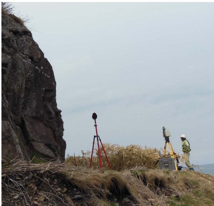
写真 3.15 レーザープロファイラー観測状況と空撮用ラジコンヘリコプター
