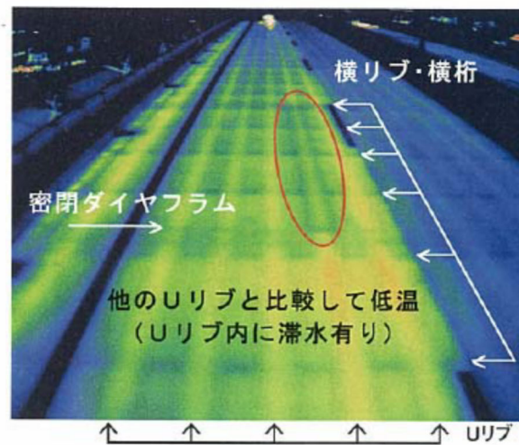
図 5.3 鋼床版Uリブ内部の滞水調査の適用事例
