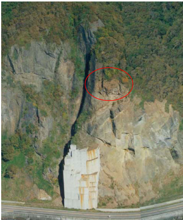
写真 3.7 斜め空中写真による岩盤崩壊発生源の確認
