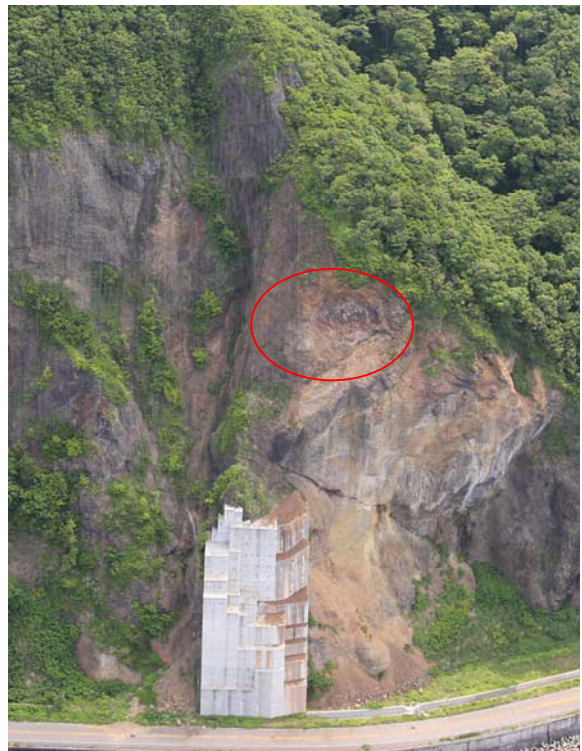
写真 3.7 斜め空中写真による岩盤崩壊発生源の確認
