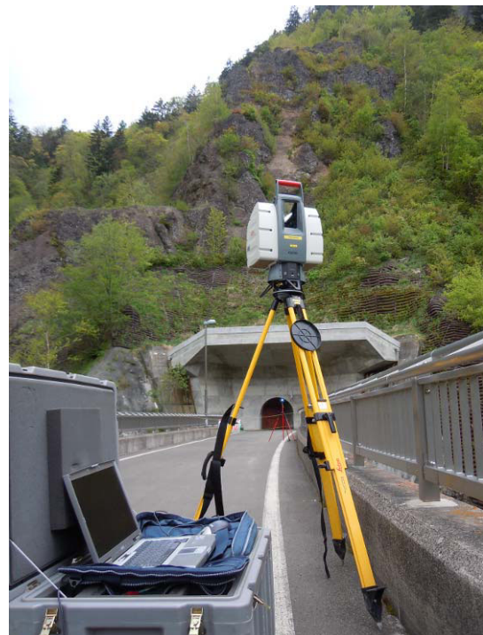
写真 3.10 使用機器と制御用 PC
