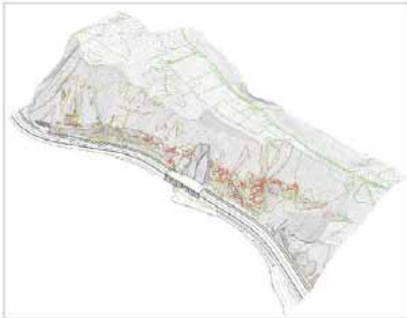
図3 3次元地形モデルへの亀裂等の表示例
