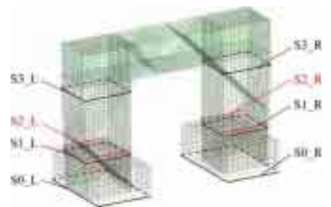
(b) 橋軸直角方向載荷 (—：主鉄筋段落し位置)
