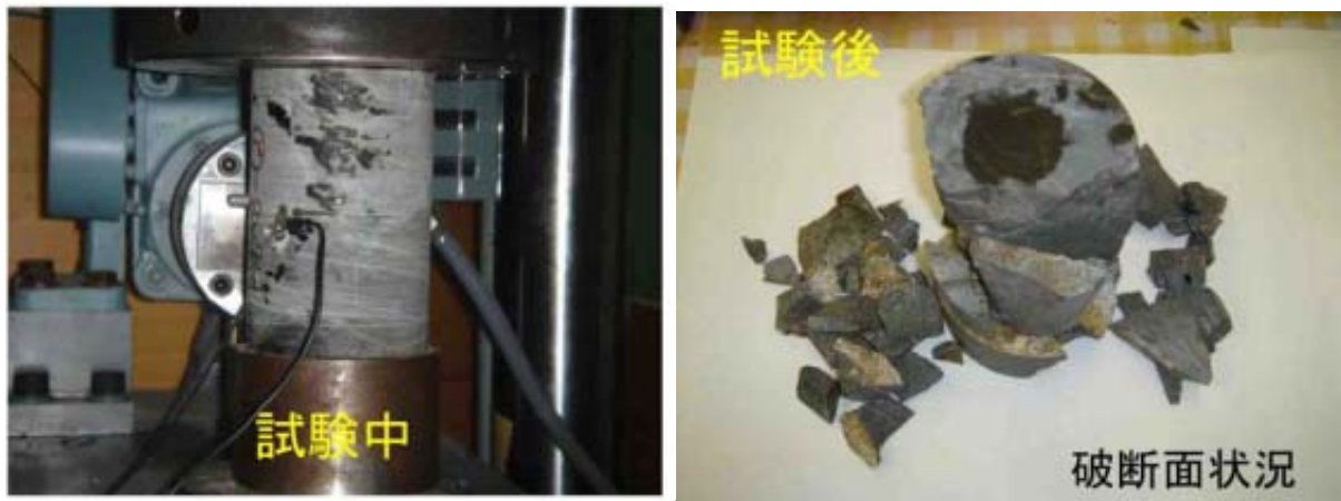
図 7 - 3 4 破壊音に着目した試験状況
