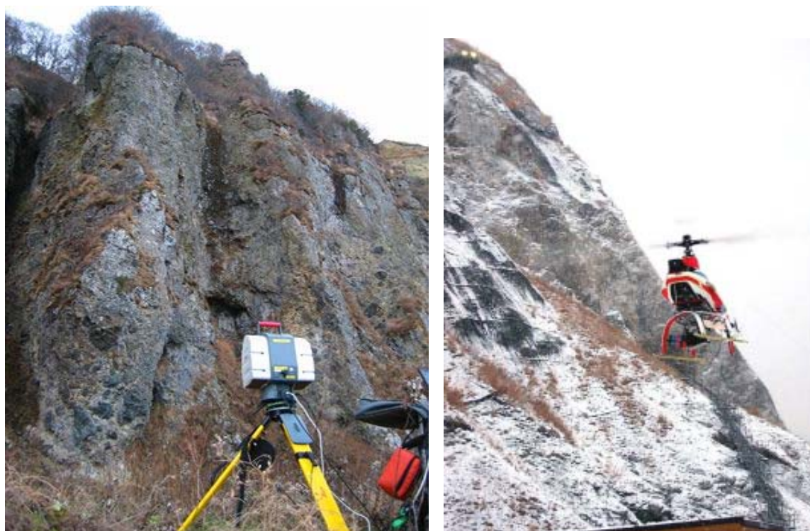
図7 - 4 1 地上設置型レーザープロファイラーとラジコンヘリによる空中写真撮影状況
