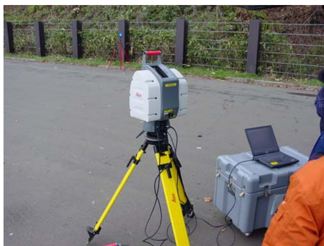
図6-1 今回の調査で用いた地上型レーザ計測器の外観
